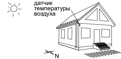
Рисунок 1. Монтаж датчика температуры воздуха
